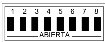
Fig. 2 - Banco de interruptores de dirección rotulado "SIO ADDRESS"
